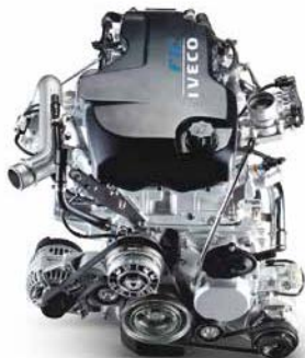
F1C motor na stlačený zemní plyn o objemu 3,0 l
